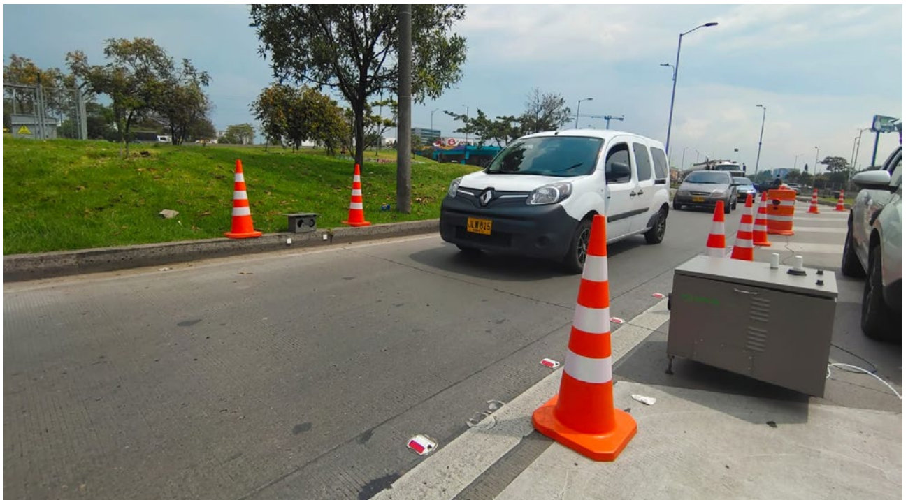
Figura 2. Recopilación de datos de detección remota mediante un instrumento portátil Opus RSD5700
