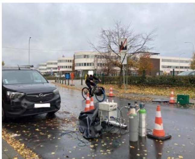
Tests par télédétection des émissions en bord de route, notamment la mesure des PM (à gauche) et le calcul du nombre de particules à l'aide d'un testeur d'émission portable (à droite), rue du Lieutenant Lotin, à Bruxelles.
